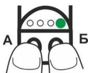
После выбора нужного режима работы нажмите кратковременно обе кнопки А и Б. Выключатель перейдет в рабочий режим. Будет светиться индикатор состояния зеленого цвета.
