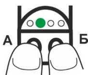
Одновременно нажать кнопки А и Б и удерживать их пока не начнет светиться индикатор режима зеленого цвета. После отпускания кнопок будет установлен режим изменения расстояния срабатывания.
