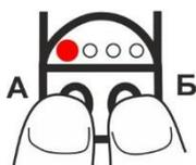
Одновременно нажать кнопки А и Б и удерживать их пока не начнет светиться индикатор режима красного цвета. После отпускания кнопок будет установлен режим задания времени задержки срабатывания.
