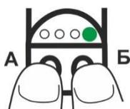
После задания нужного расстояния срабатывания нажмите кратковременно обе кнопки А и Б. Выключатель перейдет в рабочий режим и сохранит новое значение расстояния срабатывания.
