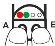
Одновременно нажать кнопки А и Б и удерживать их пока не начнут светиться оба индикатора режима. После отпускания кнопок будет установлен режим выбора задержки срабатывания.
