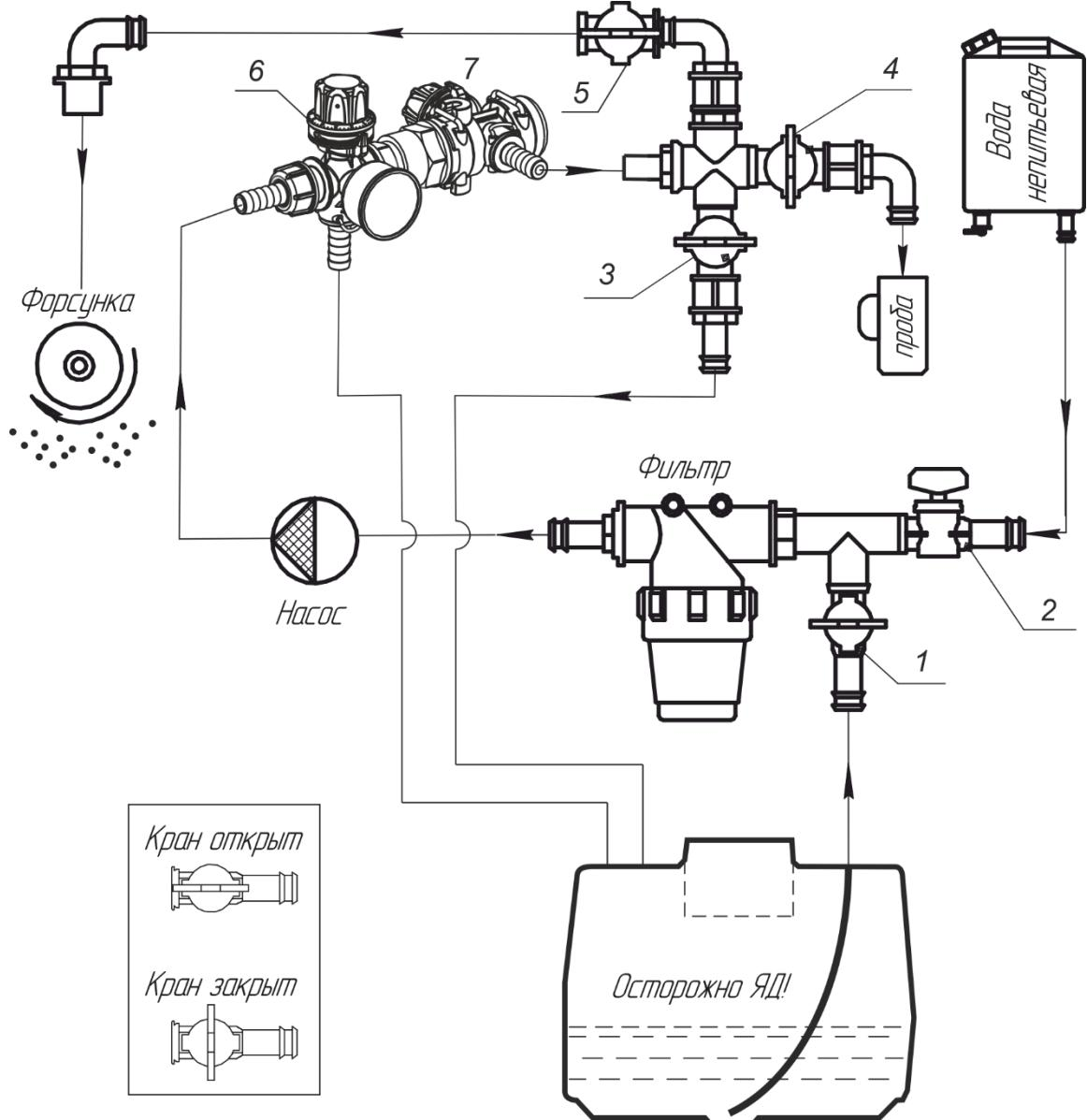
Рис. 3. Схема гидравлическая. 1-5 – краны; 6-7 - дроссельные регуляторы потока
