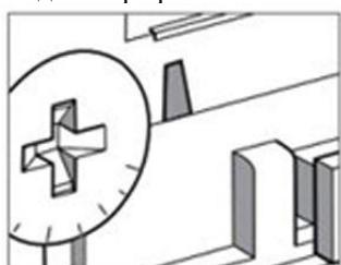
При закрытии крышки переключатель блокируется.
