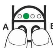
Одновременно нажать кнопки А и Б и удерживать их пока не начнет светиться индикатор режима зеленого цвета. После отпускания кнопок будет установлен режим изменения расстояния срабатывания.
