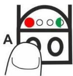
При нажатии на кнопку А устанавливаются минуты задержки (одно нажатие - одна минута). При каждом нажатии кнопки будет вспыхивать индикатор состояния зеленого цвета.
