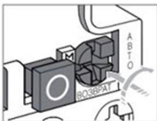
При повороте влево переключатель выводится из зацепления и переходит в режим кнопки, при нажатии на которую осуществляется ручное повторное включение. При нажатии на переключатель и повороте вправо выполняется режим автоматического повторного включения. Переключатель остается в положении автоматического повторного включения до принудительного возврата в положение ручного повторного включения.
