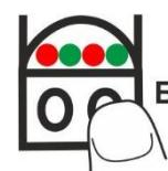
Повторным нажатием кнопки Б задержка выключения отменяется и задается режим работы без задержки. При этом будут светиться все индикаторы.
