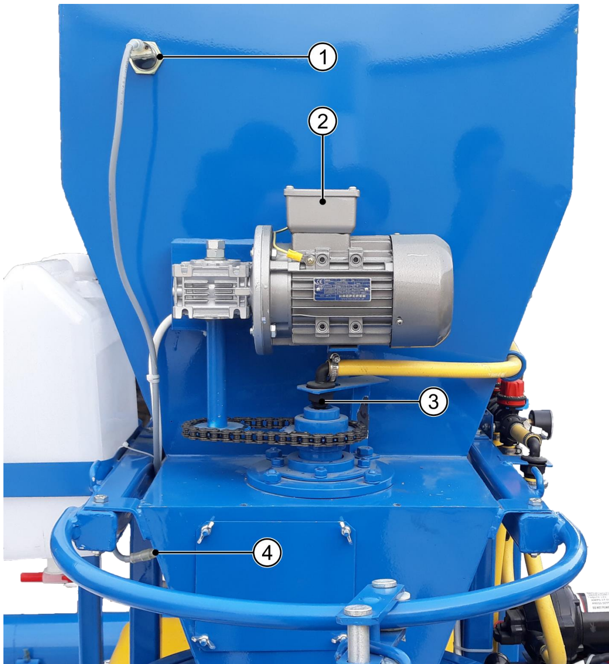
Рис. 9. Бункер зерновой (задний кожух снят).
